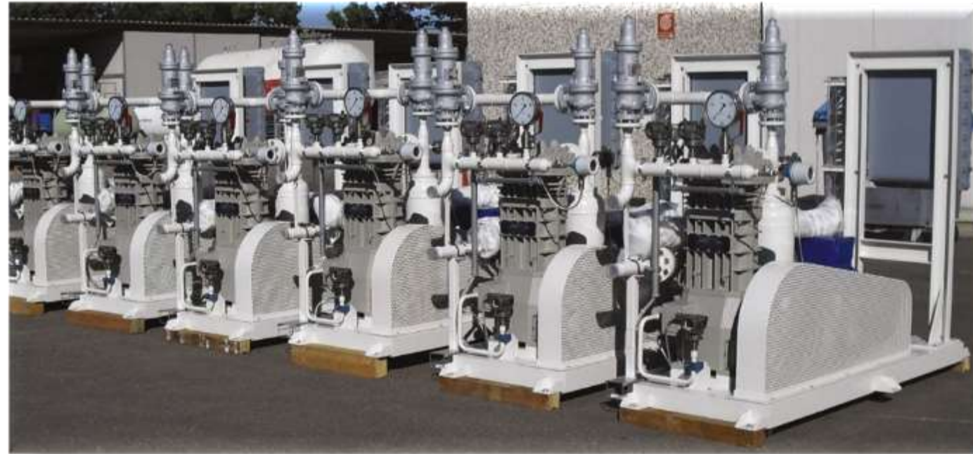
Montage du compresseur de GPL Corken
